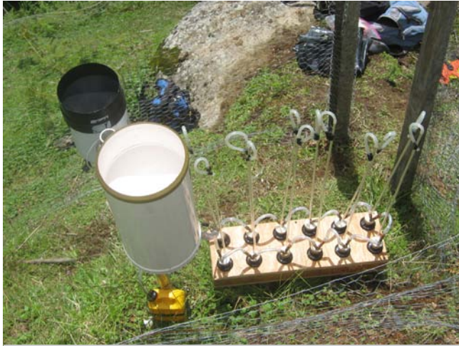
Colector de lluvia pasivo a utilizar en los muestreos. Foto: Lyssette Muñoz
