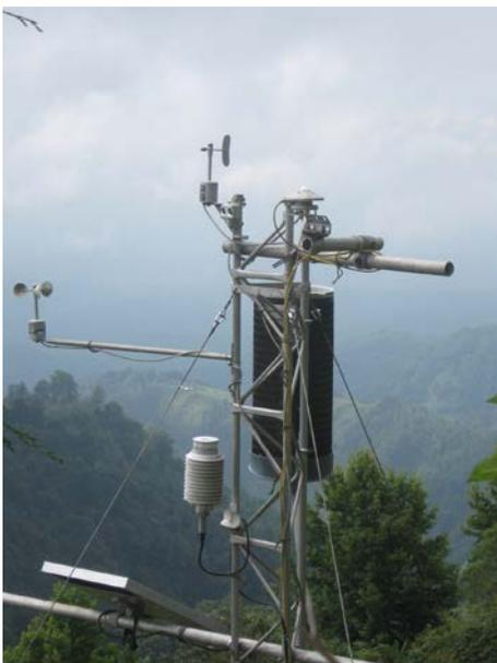
*Estación meteorológica con colector de niebla en La Cortadura.*
