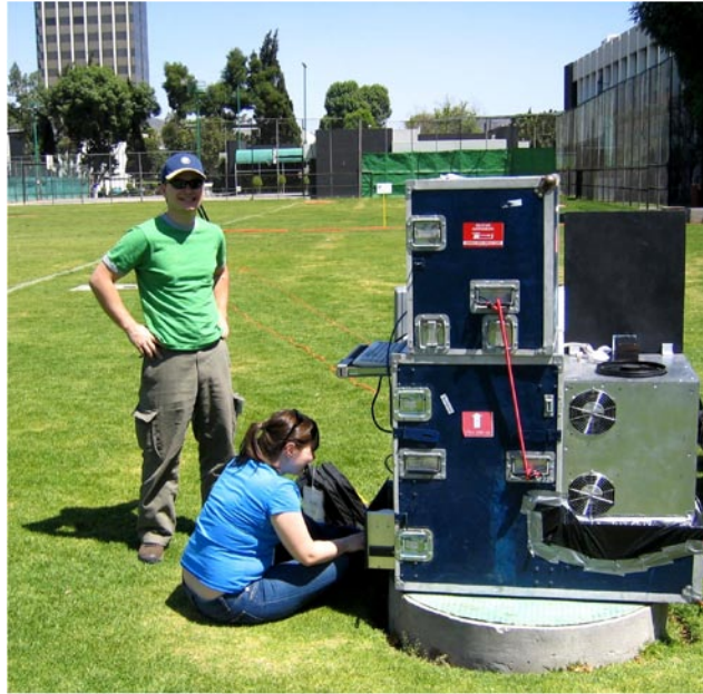
Instalación del sistema Lidar para medir la estructura vertical de aerosoles en el sitio del Instituto Mexicano del Petróleo. Piotr Lewandowski y Heidi Holder (Universidad de Iowa). (Proyecto MILAGRO).
