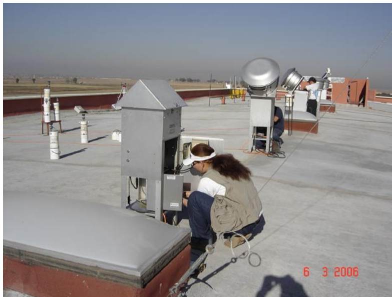
Colectores de partículas de alto y bajo volumen (HighVol y MiniVol) y al fondo impactores de cascada. Rocío Galván (CENICA). (Proyecto MILAGRO).
